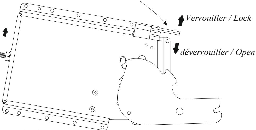
*\* Après montage, vous pouvez régler la tension avec un «écrou» en fonction du poids du lit*
