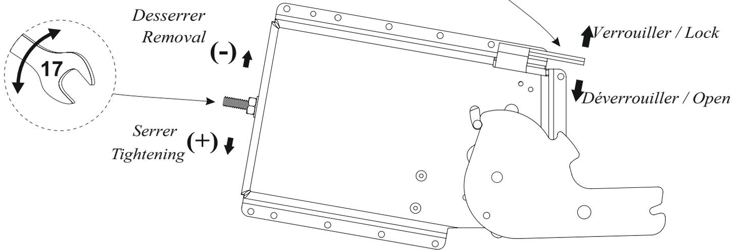
*\*Après montage, vous pouvez régler la tension avec un «écrou» en fonction du poids du lit.*
